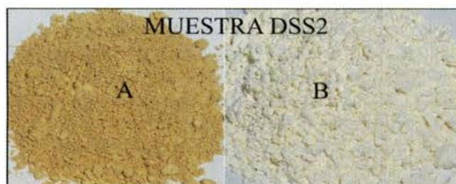
**Figura 4.4.** Color de la diatomita. A. Muestra antes de calcinar. B. Muestra después de calcinar.
