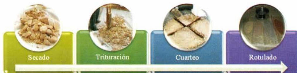
*Figura 3.2. Preparación de las muestras para los diferentes análisis*
