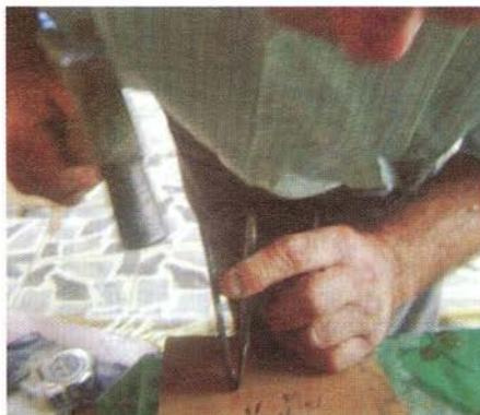
Cuando las cintas de chin están listas, se pasan por dos cuchillas especiales para pulir los bordes del material; se clavan en un pedazo de madera y se sostiene la cinta con un pedazo de caña.
