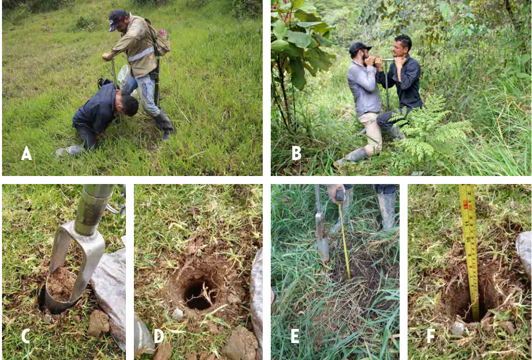
Figura 10. Toma de muestras de suelos en Sabanalarga. A-B. Uso del barreno en diferentes coberturas; C-D. Toma de muestra de suelo; E-F. Medición de la profundidad de la muestra.
