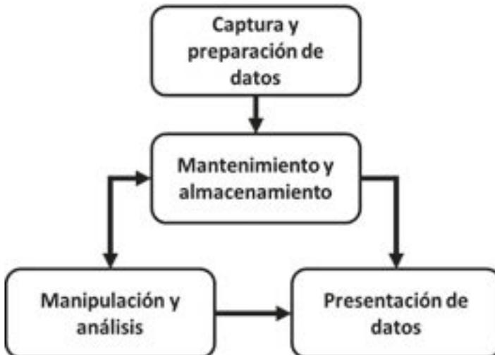
**Figura 1.** Componentes funcionales de un SIG.
