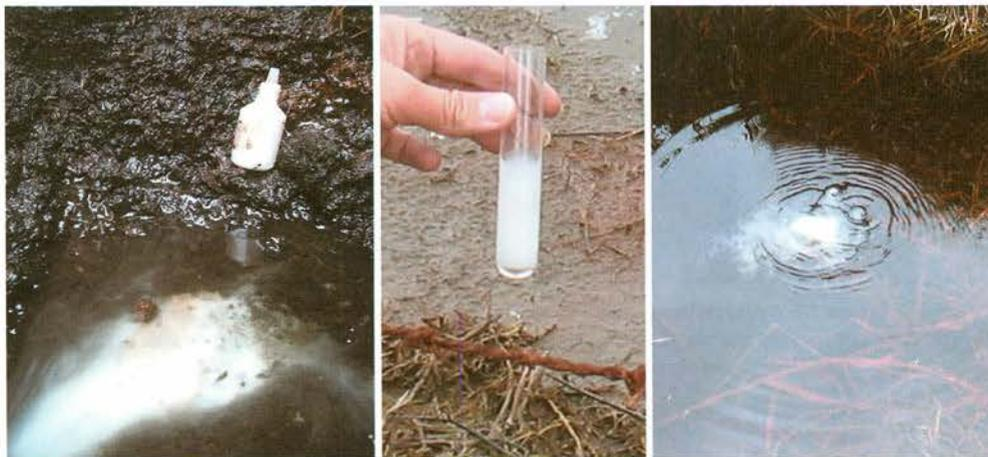
**Figura 5.6** Prueba del  $\text{BaCl}_2$  para identificar sulfatos en aguas freáticas y de drenaje de SSA. La reacción produce un precipitado lechoso.
