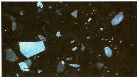
**Figura 4.31** Vista microscópica de cristales de yeso en el horizonte Oj de los *Typic Sulfohemists*. Cubeta inferior de la planicie fluvioacustre del río Chicamocha. Se observan cristales de diferentes tamaños que reflejan claramente la luz.
