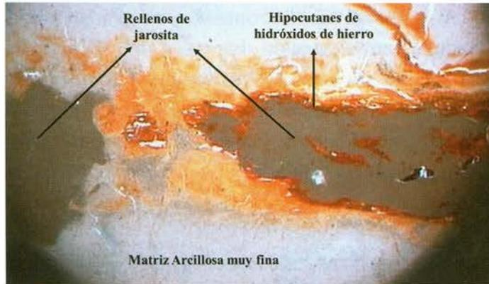
**Figura 4.27** Sección delgada del horizonte Bj de SSA valle alto del río Chicamocha. Microfotografía de luz polarizada, lente conoscópica, nicols paralelos a 140 aumentos.
