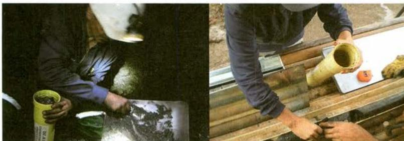
Figura 4.4 Toma de muestra en frente de mina y toma de muestra a partir de corazones.
