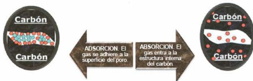
Figura 3.1 Adsorción y absorción del gas metano en el carbón.
