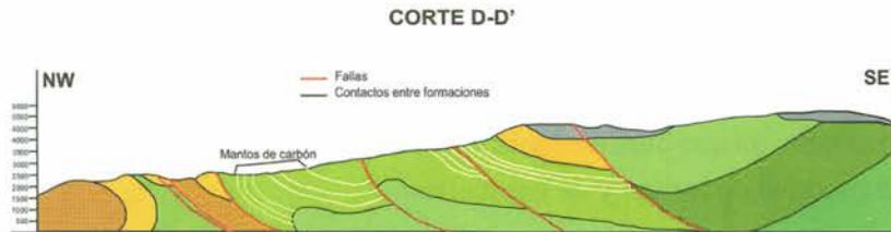
Figura 2.5 Corte o sección geológica que muestra el comportamiento de las capas de carbón a profundidad. Nótese el efecto de las fallas en la continuidad e inclinación de los mantos. Zona nororiental de Sogamoso.
