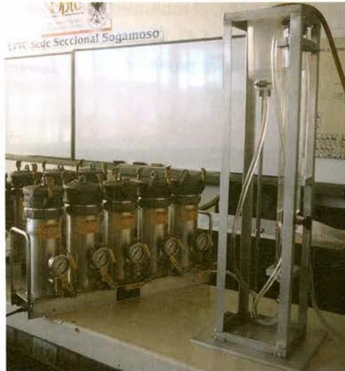
Figura 4.3 Montaje del equipo de medición de gas en el laboratorio de la UPTC-Sogamoso.
