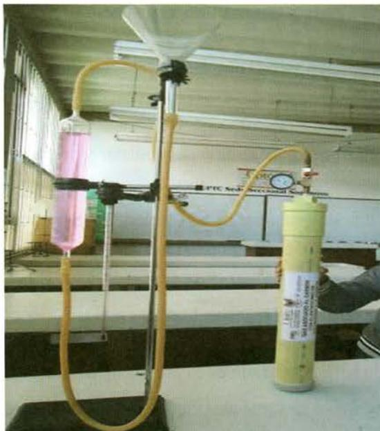
Figura 9.2 Medición del gas desorbido en el laboratorio por desplazamiento de una columna de agua.
