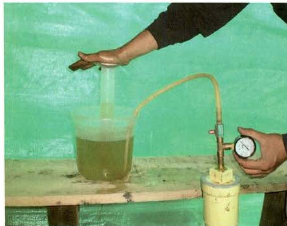
Figura 4.6 Medición en campo del gas perdido mediante el sistema de probeta invertida.
