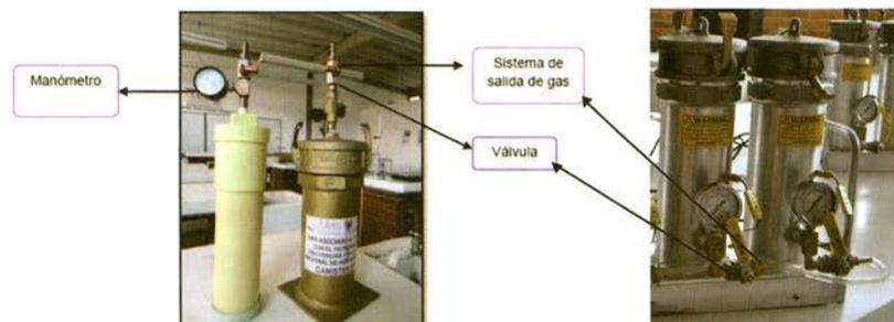
Figura 4.2 Cánister o cámaras herméticas donde se introduce el carbón durante el proceso de desorción.
