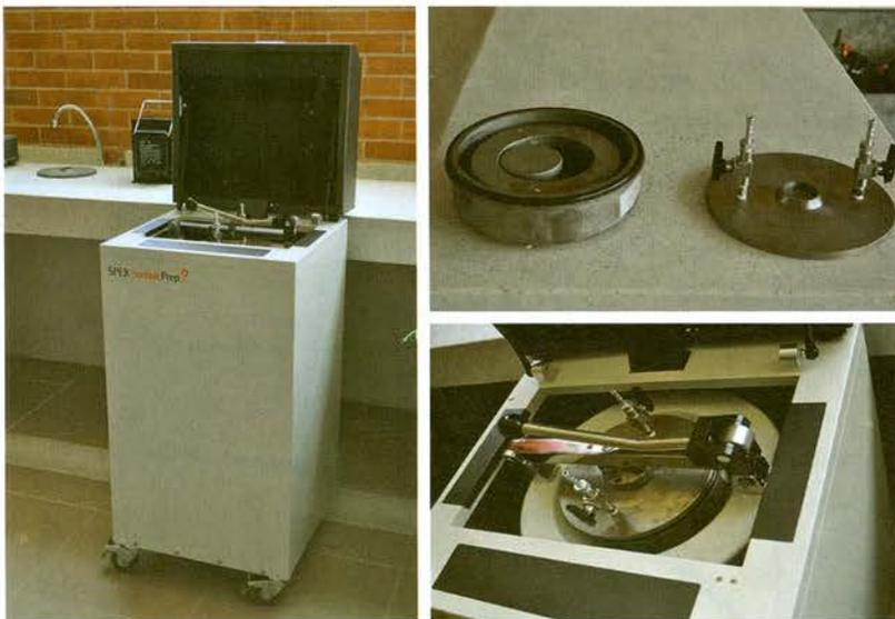
Figura 9.4 Equipos (contenedores herméticos y molinos) utilizados en el laboratorio de la UPTC para determinación del gas residual.
