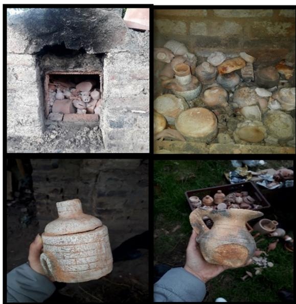
La recomendación que se comparte al grupo de ASOAMME hace referencia al control de la curva de temperatura de cocción, la cual consiste en programar un valor de referencia y mantenerlo durante un tiempo específico, así: 200 °C en 90 minutos y mantener durante 20 minutos; 500 °C en los siguientes 100 minutos; 700 °C en los próximos 200 minutos; y finalmente, 1050 °C en los últimos 75 minutos que se conserva durante 120 minutos; luego se apaga el horno y se deja enfriar progresivamente.
