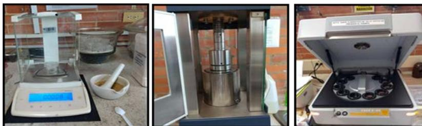
Nota. A. Muestra pulverizada en báscula B. Generación de la pastilla en prensa hidráulica C. Análisis de FRX.
