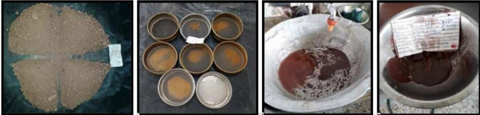
Nota. A. Cuarteo B. Tamizaje de muestra en el set de tamices C. Lavado de muestras D. Muestra lista para ser pesada.
