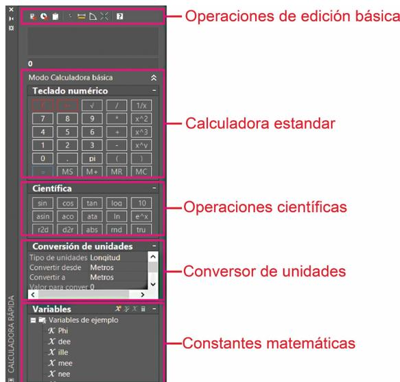
Figura 117. Módulos de la calculadora rápida.
