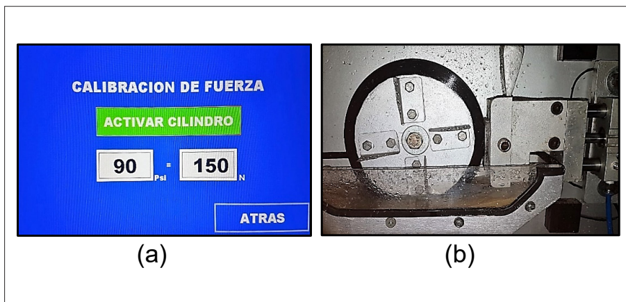
Figura 57. (a) Pantalla de calibración de la fuerza; (b) Probeta sobre el disco estático.
