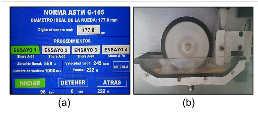
Figura 59. (a) Pantalla del ensayo 1 en ejecución; (b) Proceso de desgaste G105.
