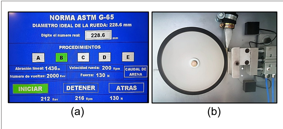
Figura 51. (a) Pantalla del proceso en ejecución; (b) Proceso de desgaste G-65.
