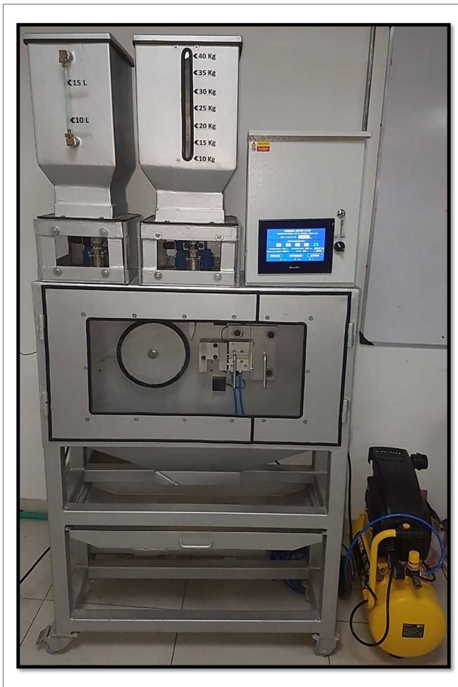
Figura 45. Vista final del tribómetro automatizado.
