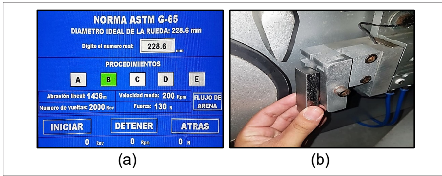
Figura 47. (a) Elección de procedimiento B; (b) Puesta de probeta.
