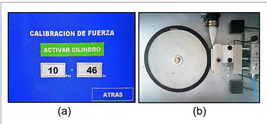
Figura 49. (a) Pantalla de calibración de la fuerza; (b) Probeta sobre el disco estático.
