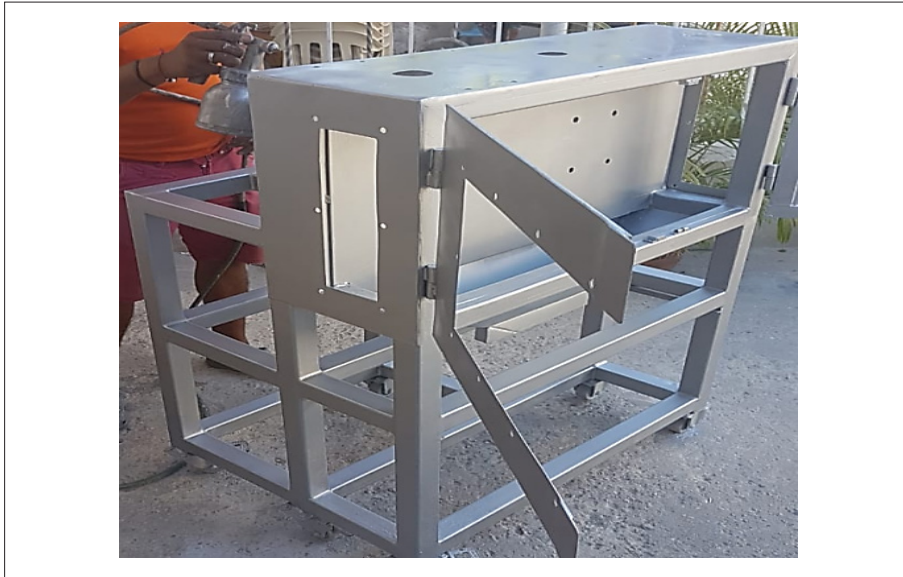
Figura 42. Estructura en el proceso de aplicación de pintura.
