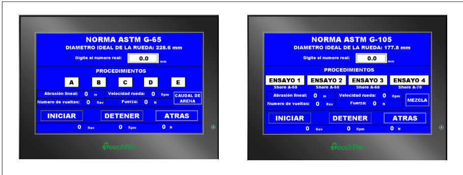
Figura 19. (a) Pantalla de la norma G65; (b) Pantalla de la norma ASTM G105.
