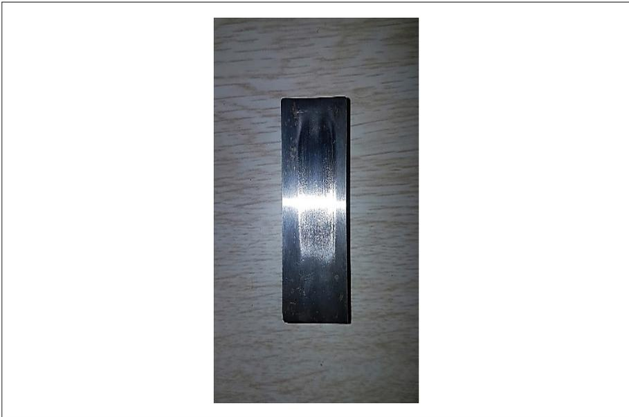
**Figura 61.** Probeta de Acero 4140.
