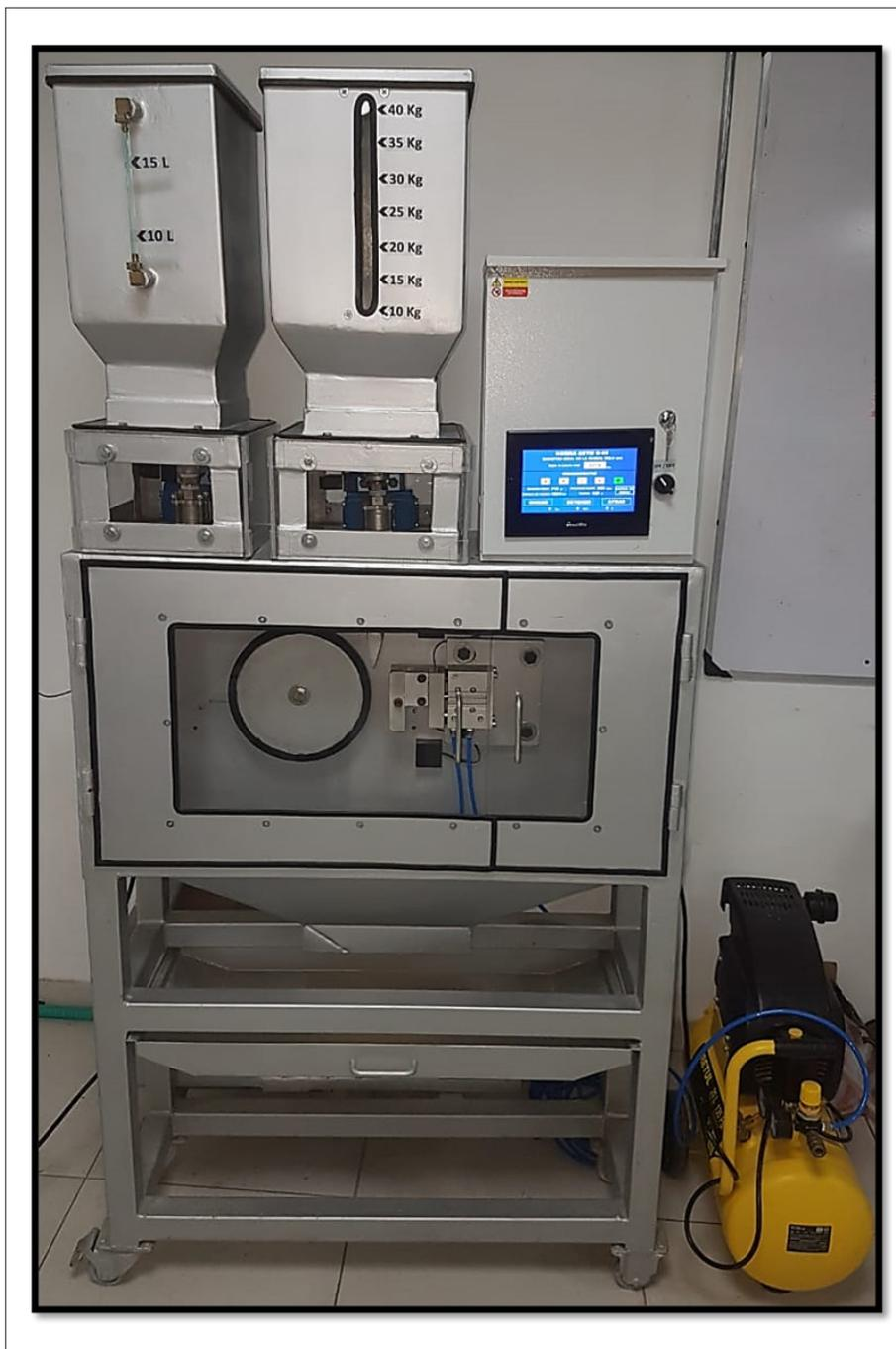
**Figura 45.** Vista final del tribómetro automatizado.
