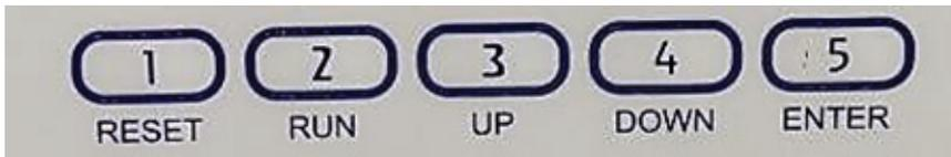
**Reset 1:** Permite reiniciar y regresar a la pantalla principal para establecer una nueva configuración y eliminar la que se haya realizado previamente.
