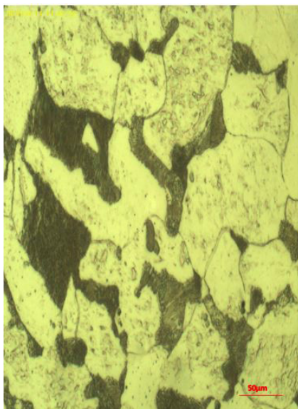
Figura 3.2: Micrografía óptica del acero AISI SAE 1020. Fuente: el autor.
