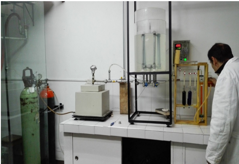
Figura 20. Sistema de gasificación a nivel de laboratorio.
