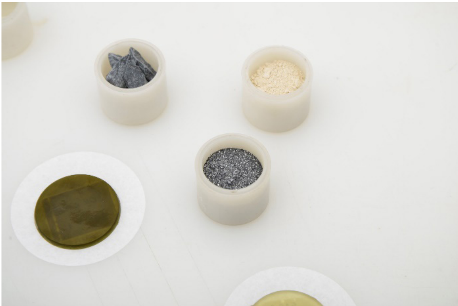
Figura 7. Montaje de muestras para fluorescencia de rayos X.
