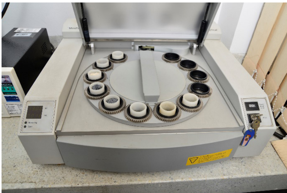
Figura 6. equipo de fluorescencia de rayos x
