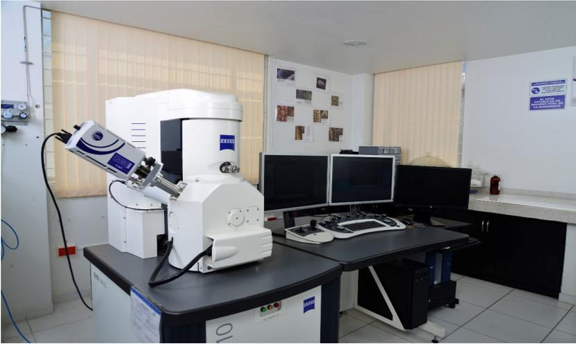
Figura 11. Equipo de microscopía electrónica de barrido
