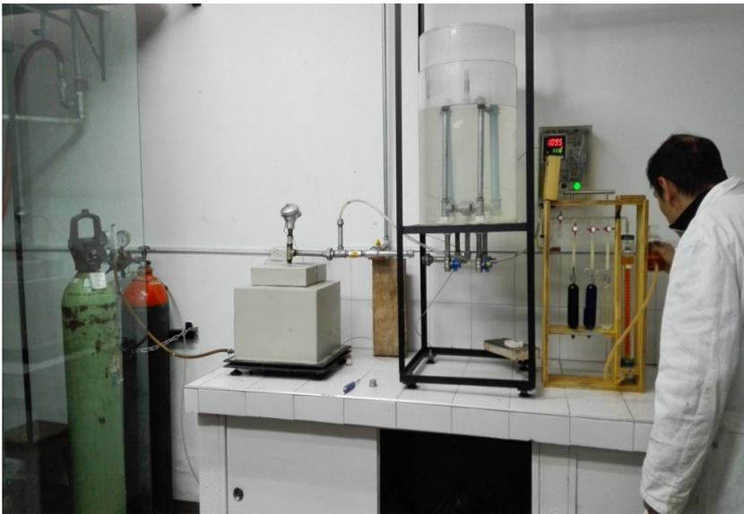
Figura 20. Sistema de gasificación a nivel de laboratorio.
