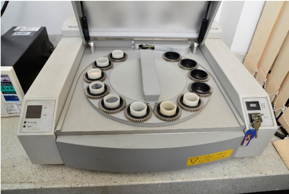
Figura 6. equipo de fluorescencia de rayos x
