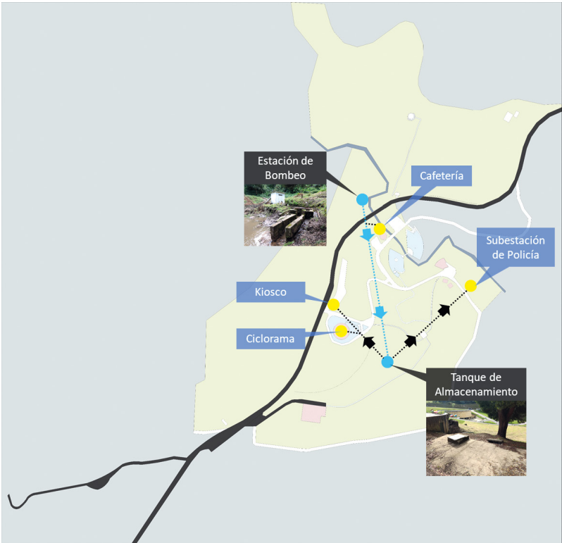
Imagen 56. Operatividad del sistema interno de acueducto. Fuente: Parra, G., Gonzales, D., Rojas, G., 2017.
