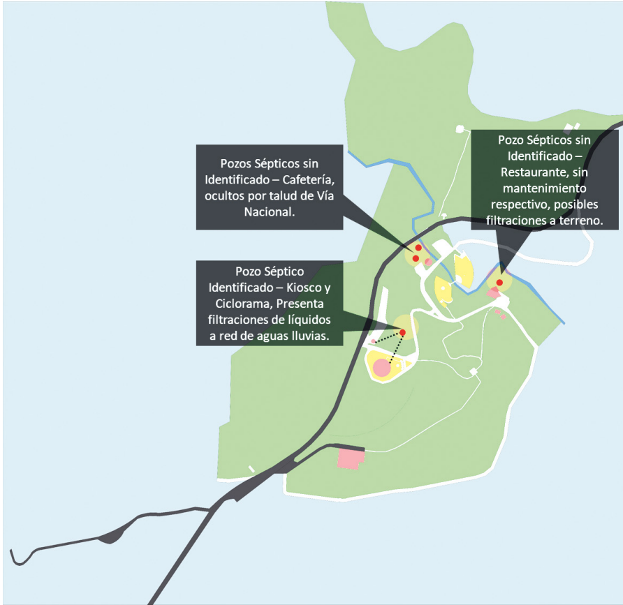
Imagen 57. Elementos identificados en terreno de la red de manejo de aguas negras y zonas de riesgo. Fuente: Parra, G., Gonzales, D., Rojas, G., 2017.
