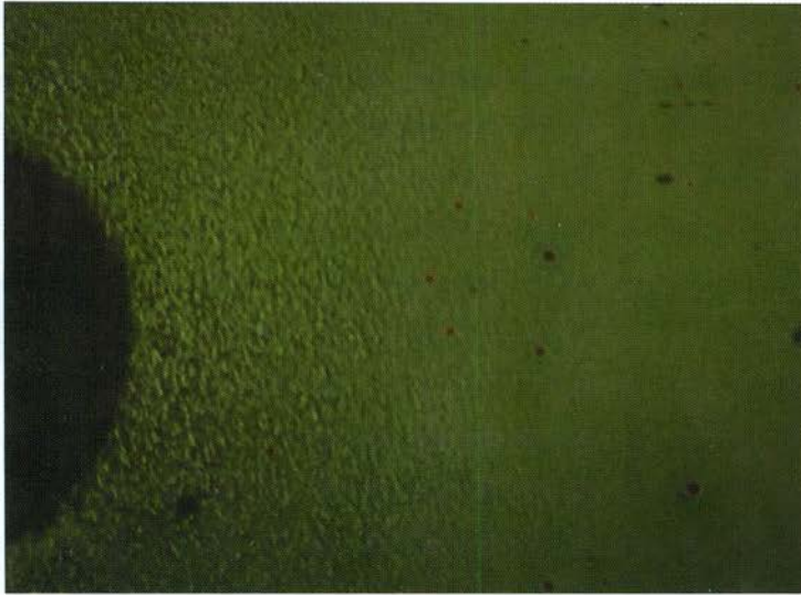
Figura 4.14. Evaluación de la adhesión de una tricapa del sistema \text{SiO}_2\text{-TiO}_2\text{-ZrO}_2 con una concentración Si/Ti/Zr: 10/70/20.
